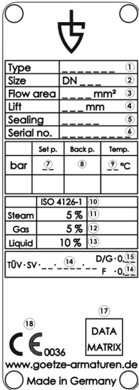
As válvulas de segurança são testadas por nós para resistência à pressão e estanqueidade, ajustadas à pressão de ajuste desejada e vedadas. A identificação está marcada de maneira indelével na placa de identificação ou no castelo da válvula. Além disso, a identificação contém as informações necessárias de acordo com a DIN EN ISO 4126-1.
