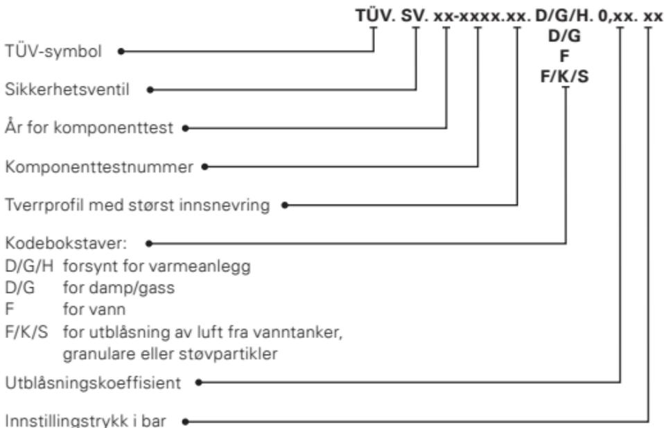
Vi kontrollerer sikkerhetsventilene for trykkmotstand og stramhet, justerer påkrevd innstillingstrykk og forsegler dem.
