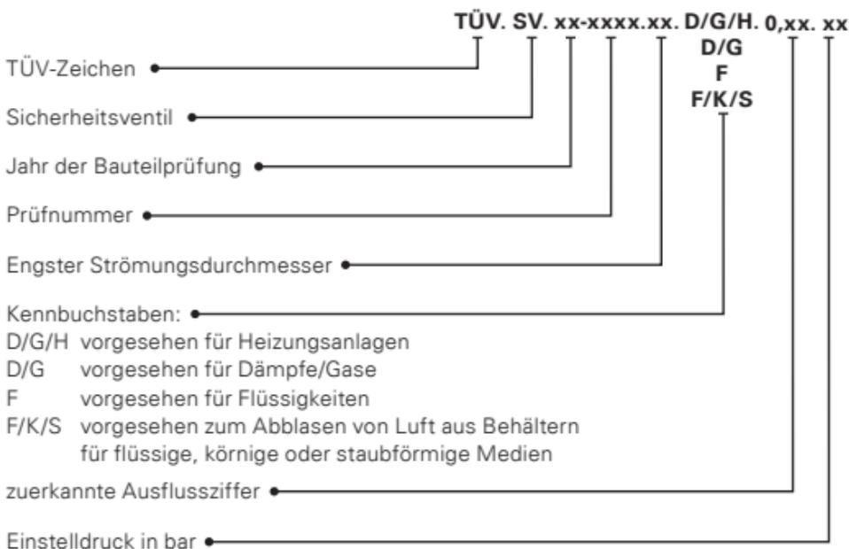
Sicherheitsventile werden von uns auf Druckfestigkeit und Dichtheit geprüft, auf den gewünschten Einstelldruck einjustiert und plombiert.
