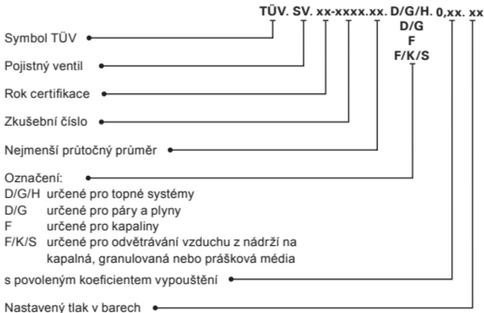
Pojistné ventily jsou zkoušeny na pevnost a těsnost a seřizeny a zaplombovány na požadovaný nastavený tlak.
