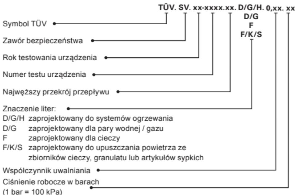
Sprawdzamy zawory bezpieczeństwa pod kątem odporności na ciśnienie i szczelność, ustawiamy ciśnienie robocze według wymagań klienta i plombujemy je. Kod identyfikacyjny na tabliczce znamionowej lub pokrywie sprężystej zaworu jest nanoszony z użyciem systemu permanentnego oznaczania. Dodatkowo oznaczenie zawiera informacje wymagane normą DIN EN ISO 4126-1.
