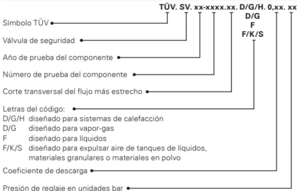
Revisamos las válvulas de seguridad para comprobar la resistencia a la presión y la estanqueidad, ajustamos la presión de reglaje requerida y las sellamos. La identificación en la placa del tipo o en el sombrerete de resorte de la válvula se aplica mediante un sistema de marcado permanente. La placa del tipo se marca adicionalmente con códigos de identificación y datos técnicos de conformidad con DIN EN ISO 4126-1.
