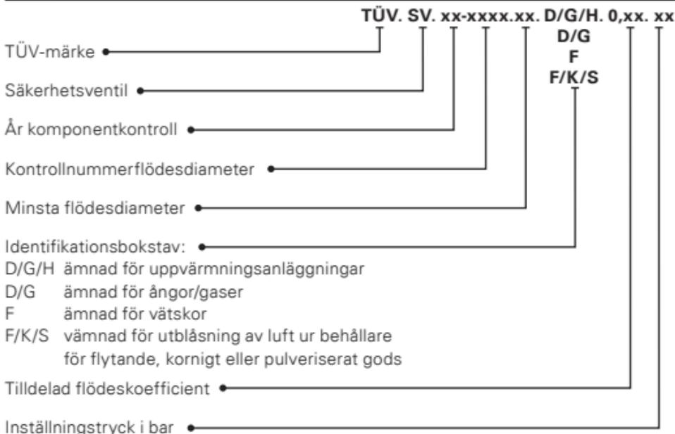
Säkerhetsventilerna kontrolleras på tryckhållfasthet och täthet, justeras in på önskat inställningstryck och plomberas.
