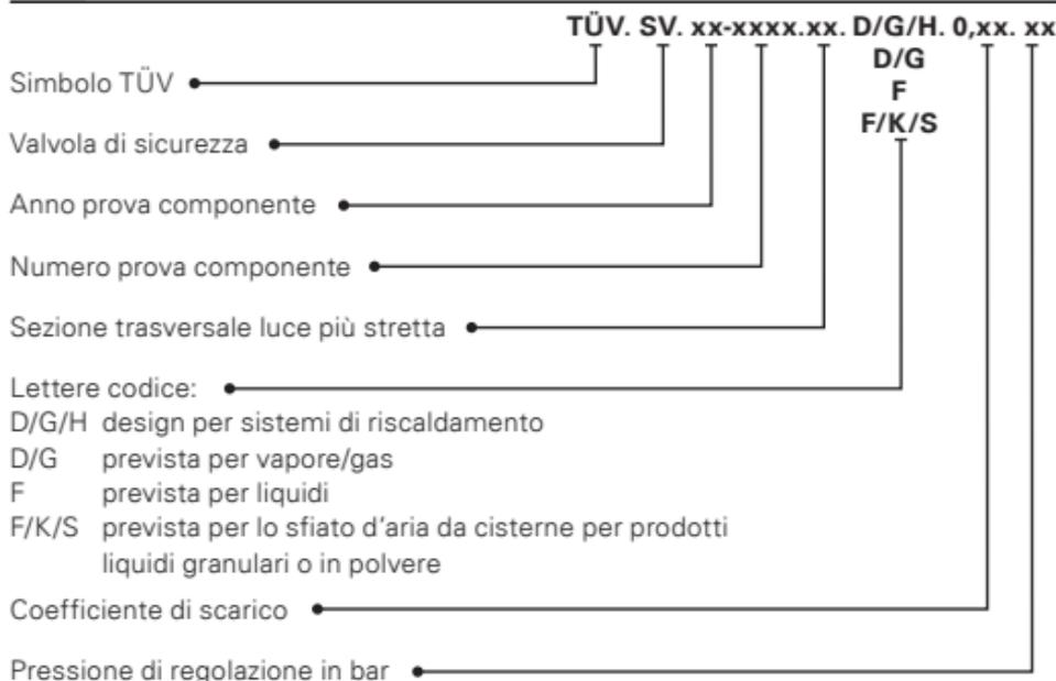
L'azienda verifica le caratteristiche di resistenza alla pressione ed ermeticità delle valvole di sicurezza, procede alle regolazioni secondo la pressione richiesta e sigilla le valvole.
